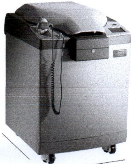
เครื่องปั่นแยกโลหิตและ ส่วนประกอบโลหิตอัตโนมัติ
